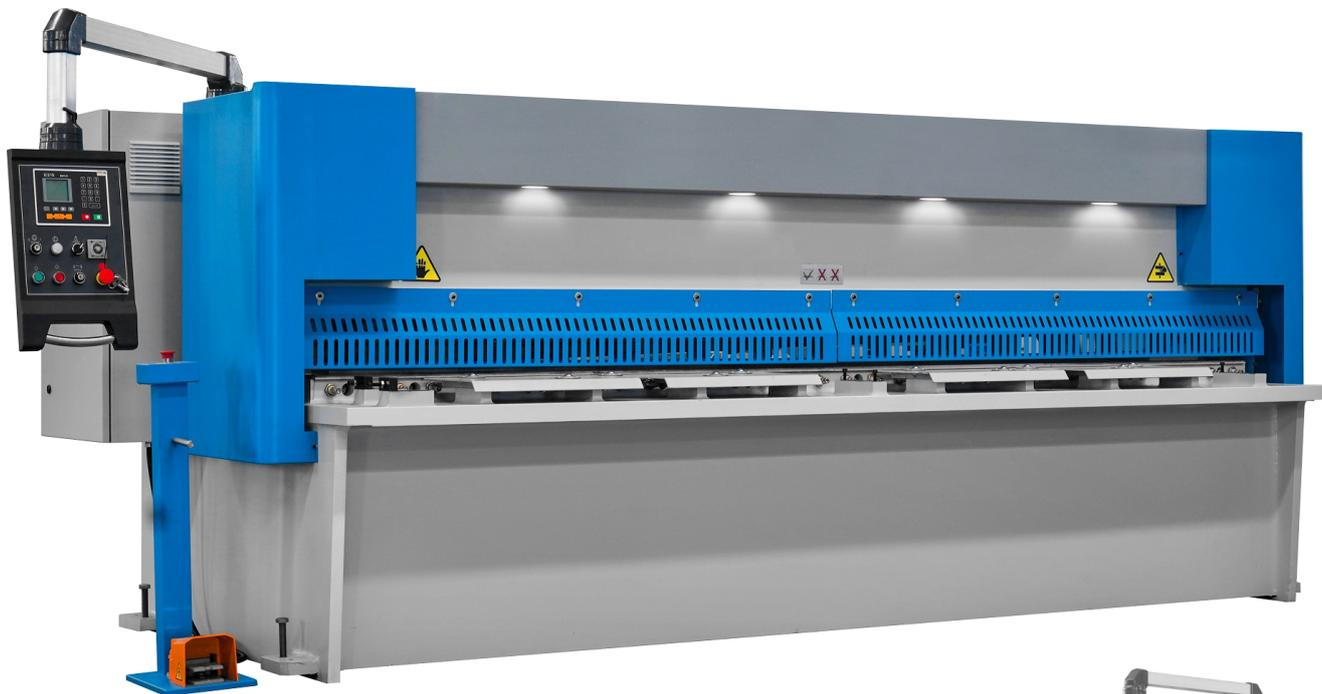
As guilhotinas da linha GH possuem acionamento hidráulico e diversas opções de espessura e largura de corte.
